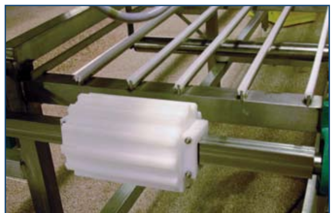
Abbildung 5: SuperDrive™ Antriebstrommel mit normaler, quadratischer Welle
