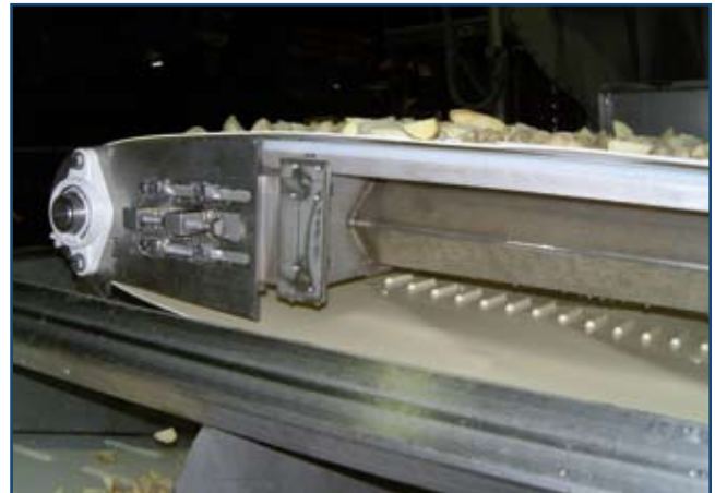
FHW-3-SD integrierte Verzahnung dient als Bandführung
